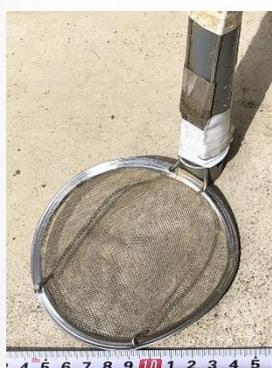
図3 砂面の簡易採取道具
