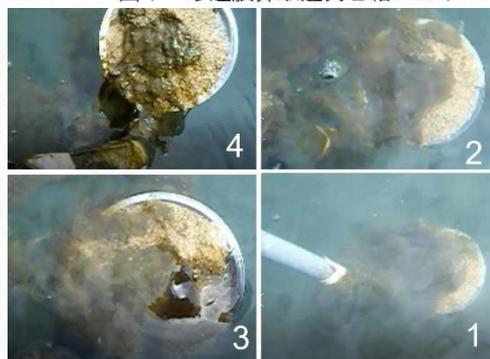
図4 水中の藻類被膜は真綿状、水面から持ち上げるとベタとなり砂も汚れる
