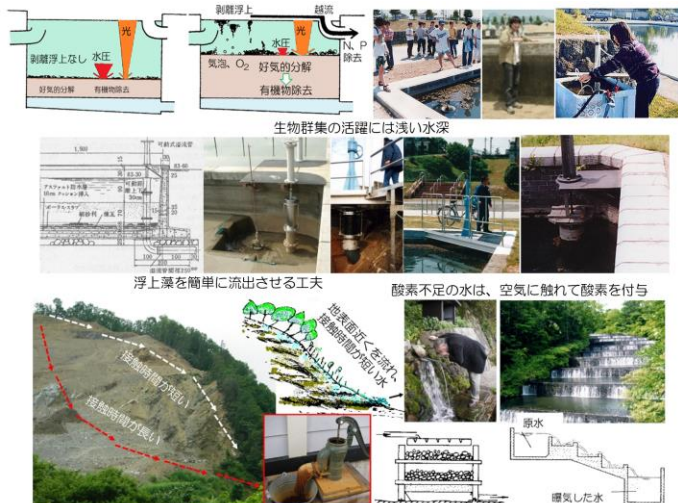
55 越流管が重要。酸素不足の水なら曝気を。
