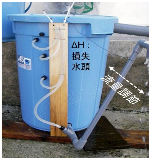
図24 バケツモデルで損失とろ過速度の関係を解説した
