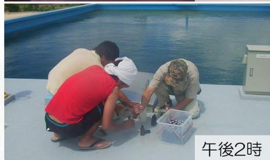
図27 溶存酸素の日変化を測定
