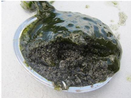
図26 正常の砂層（上）の砂は白く、砂層が酸素不足になると黒い砂層（下）になる。
