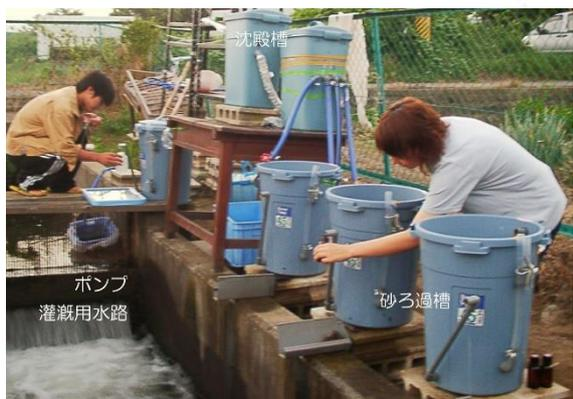
図10 灌漑水路の水を使ってモデル実験
