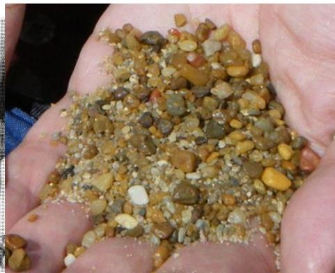
図36 英国エジンバラ浄水場のろ過砂
