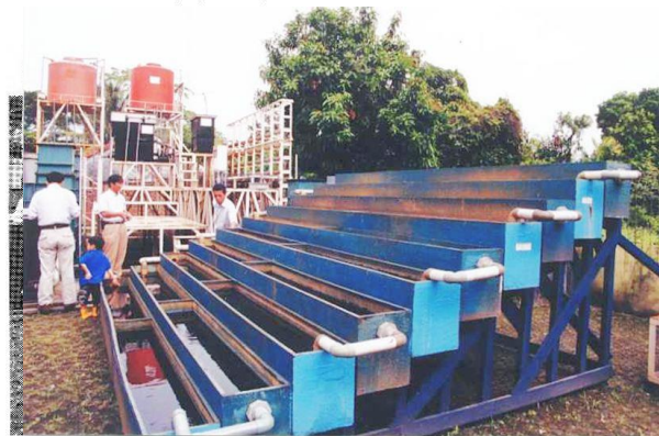
図12 地下水を長い水路で酸化処理
