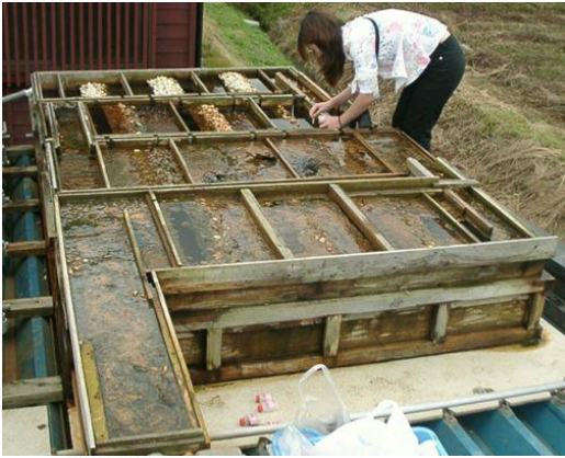
図10 長い水路で酸化処理
