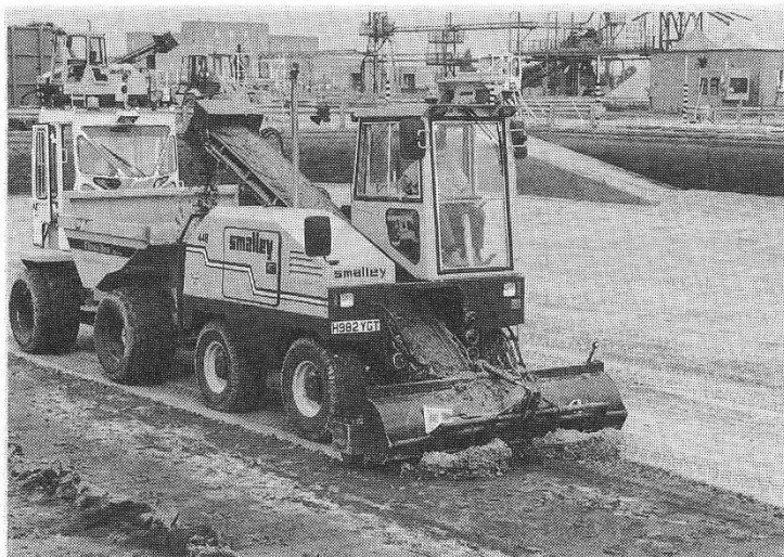
写真8 削り取り車=スマーリー= (アシュフォード・コン ン浄水場)
