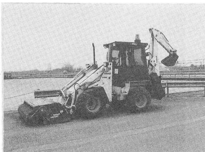
写真11 削り取り車＝ボブキャットスウィーパー＝ （カッパーミルズ浄水場）
