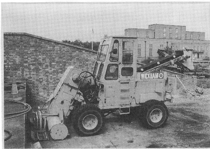
写真9 旧式の削り取り車=ウィッカム=
