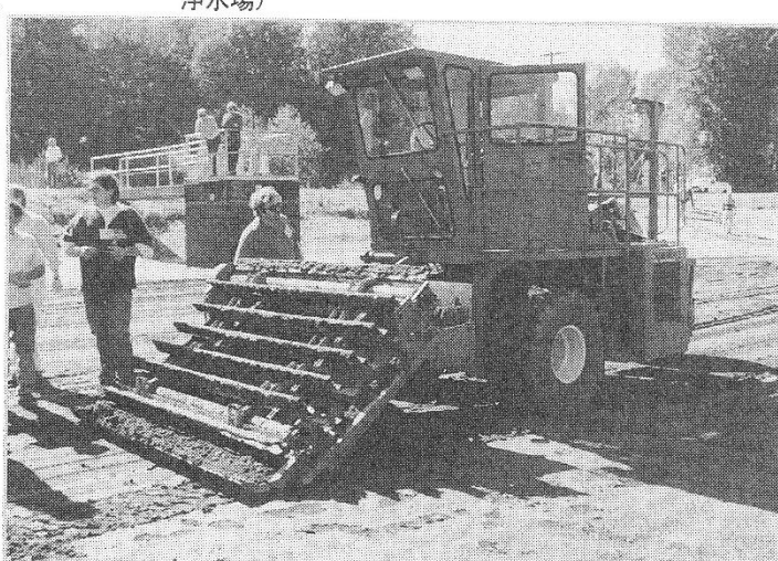
写真15 削り取り車 米国オレゴン州のコンバインを改造したも のだという。3輪の幅広タイヤを持つ。
