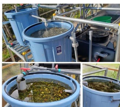
図36 120リットルバケツでの浄化装置
