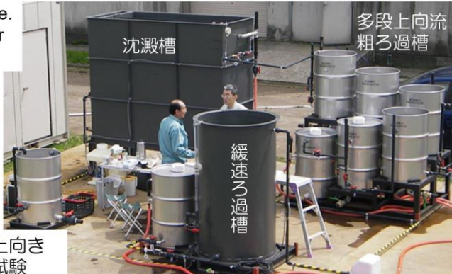
図29 上向流粗ろ過実証試験
