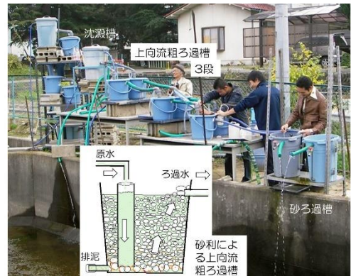
図13 バケツを使って粗ろ過実験
