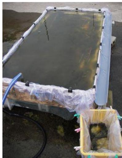
図26 浮上藻を自動的に捕集する仕組み
