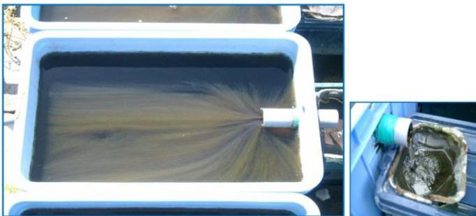
図17 湧水モデルでの糸状珪藻の繁殖状態
