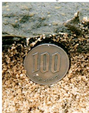
図43 砂面は水を抜くとベタリする
