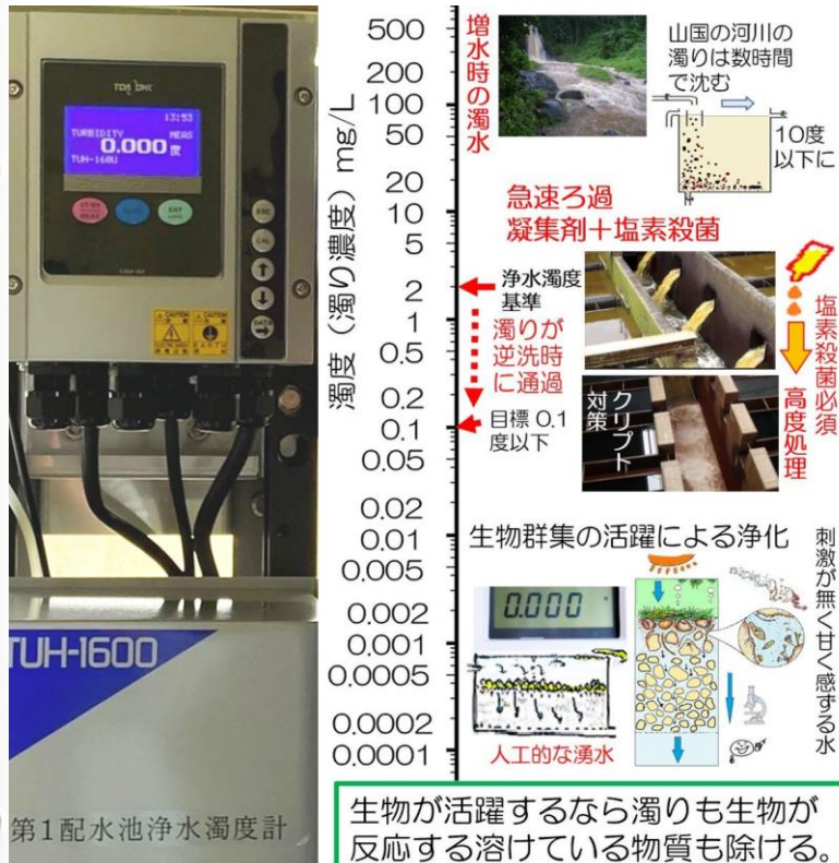
図48 0.000度の浄水濁度
