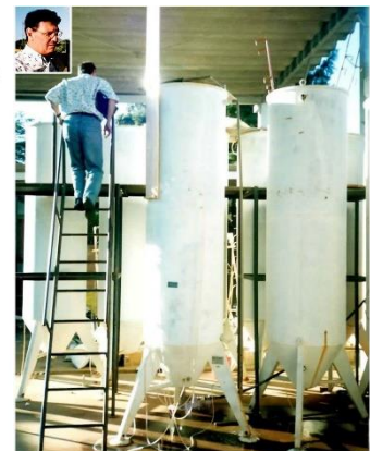
図40 粗ろ過実験塔
