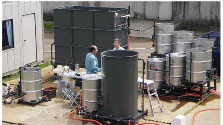
図42 粗ろ過パイロット試験
