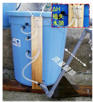
図39 損失（水面差）とろ速は比例
