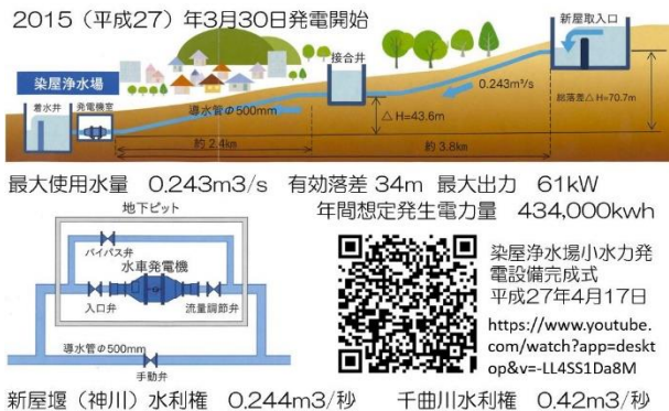
図16 水位差を利用した小水力発電
