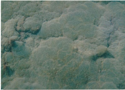
図29 凝集剤を入れた時の砂面
