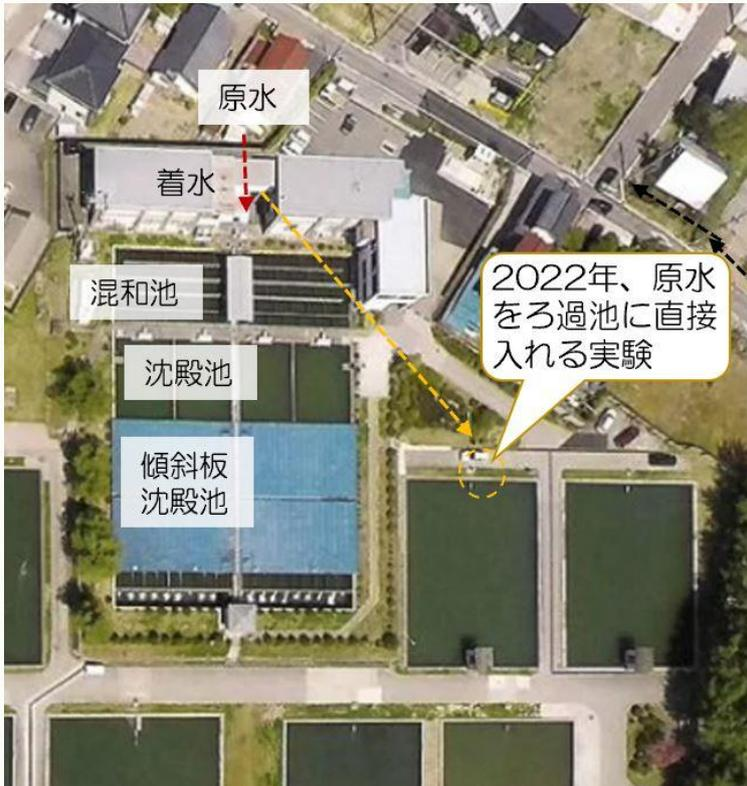
図11 原水を直接にろ過池へ
