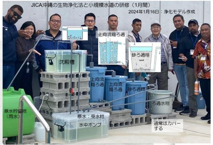
図9 実用サイズのモデルを作成
