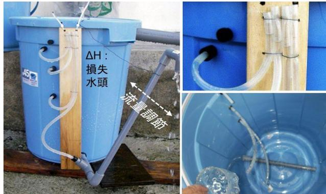
図7 ろ過抵抗の仕組みを説明
