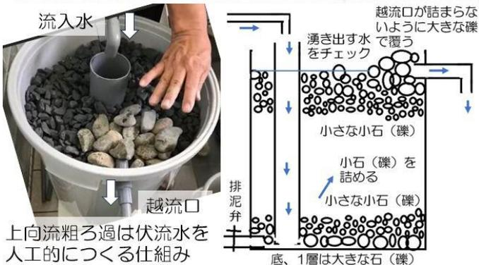
図12 バケツで上向流粗ろ過
