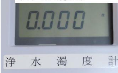
図18 ろ過水濁度は0.000度
