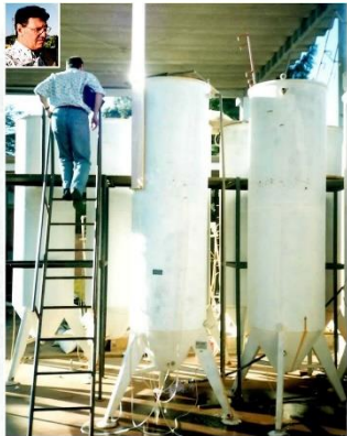
図11 ベルナルドの粗ろ過実験装置
