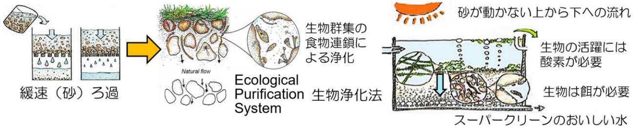
図28 機械的な篩いろ過でなく生物群集による浄化
