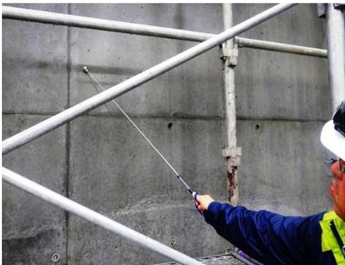
図24 コンクリート診断士による診断
