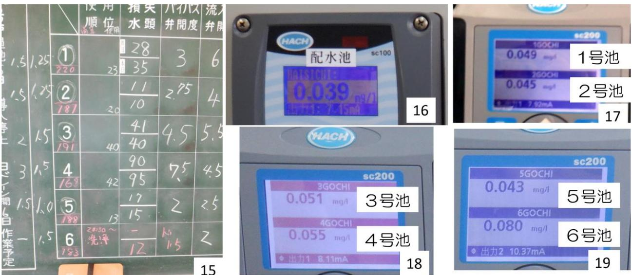
ろ過池の使用日数は 40 日程度で、使用日数が増すと損失水頭が高くなり、抵抗が増えている様であった。浄水濁度は、クリプト原虫対策での目標の 0.1 度よりは小さい値であった。
