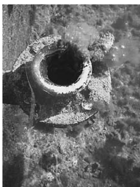
図5. 水面に浮いてきた藻類被膜は越流管から流出し、連続培養状態であった。流出口には、藻類被膜が持ち上げた砂が落ちていた。
