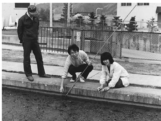
図 17. 上田市で緩速ろ過処理の研究を始めた 1984 年、ろ過池には、糸状珪藻メロシラがもの凄く繁殖していた。プランクトンでなく、新しい調査方法を考えないといけなくと暗中模索が始まった。まず、採取道具の開発からであった。支柱に網やスコップをつけて、採取しようとした。砂層表面を痛めては浄水場職員から嫌われる。そこで、水を張ってあるろ過池の砂層表面の藻類被膜だけを定量的に吸引採取できる道具を開発し、研究が進んだ。
