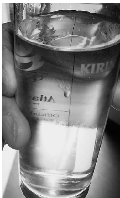
図9. ポンプ室のメーターを見ると、確かに、濁度が高かった。濁度計に入る水を、コップに汲んで良く見たところ、細かな気泡が生じていた。飲んでみても、おいしい水であった。濁度の正体は、ろ過水中の溶存酸素が過飽和状態になり、メーターのところで、攪拌され、大気圧と平衡状態になろうとして気泡が生じていたのがわかった。
