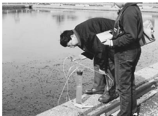
図 27. 水温が低い 3 月、ろ過池では、糸状珪藻メロシラが大繁殖していた。上田では、耕作期間で農耕地から流出する肥料成分が増える 6 月から秋にメロシラが大繁殖していた。この違いは、原水中の栄養塩の濃度が千曲川の水より数倍も濃いからかと思われた。
