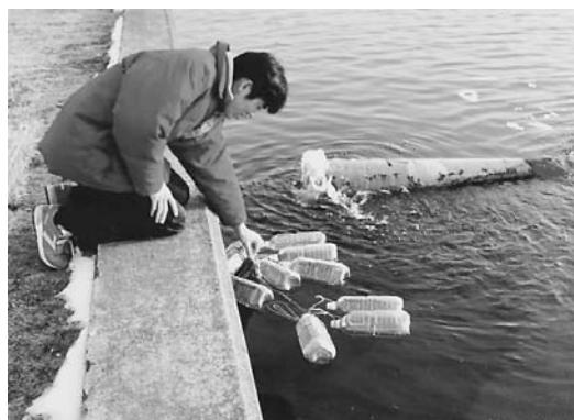
図 28. テムズ水道の原水は下水の影響で栄養塩が高い。英国より、日射量が多い日本である。冬に珪藻が繁殖しないのは、栄養塩不足である可能性があった。そこで、ろ過池にペットボトルを浮かべ、栄養塩を添加して藻が増えるかどうかと実験をした。その結果、栄養塩を加えたら確かに珪藻は増えた。
