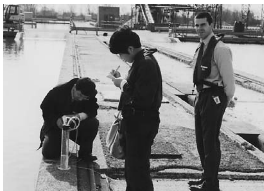
図 18. 英国政府から研究助成金を得て、テムズ水道の緩速ろ過池の調査を始めた。最初は夏に行き、テムズ水道の研究者に上田市の緩速ろ過池の状況を説明したら、冬は糸状珪藻のメロシラが凄いと教わった。そこで、観光シーズンでないが、雪が時々、舞ってくる様な3月に調査した。ろ過池の周囲にはレールが敷いてあり、昔は、大型機械で削り取り作業をしたが、水没したことがあり、使わなくなったとのこと。
