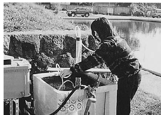
図 31. 合成樹脂製の廃棄風呂桶で緩速ろ過モデルをつくり実験をした。冬の寒い時期、隣の実際のろ過池では、糸状珪藻メロシラは繁殖していないが、水深が浅いモデルでは糸状珪藻が盛んに繁殖した。ろ過池が深いためであった。
