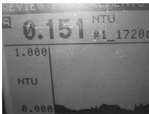
図3. 悩みの種は、ろ過水濁度が0.1度以上になることであった。数値は、激しく変動しているのが、液晶パネルでわかった。原水濁度より高い値になるので困っていた。
