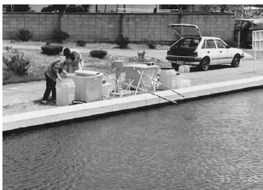
図 30. 上田市は5月中旬から糸状珪藻メロシラが目立ち始める。そこで、4月中旬にも食品添加用試薬の栄養塩を添加する実験をしたが、やはり、藻は繁殖して来なかった。結果がマイナスの論文は、学会誌に投稿しても受理してくれなかった。大金を使ったが、残念であった。後にわかったことは、原水が多少濁っていて水深が深いので、底の砂層面には藻類が繁殖するのに必要な十分な日射が足りなかったのであった。研究は失敗から学ぶことが多いのがわかった。教科書の知識だけでなく、実際に実験をし、確かめないと気づかない。
