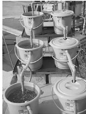
図 110. 粗ろ過装置は、上向きに水を流し、粗ろ過槽で藻類を繁殖させる場合と、させない場合での濁り除去効果を実験した。
