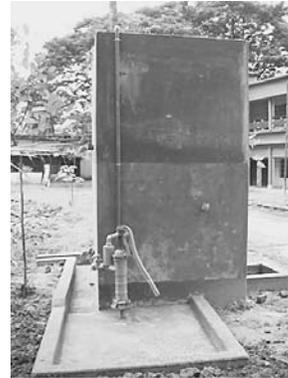
図 127-2. 川本君は中本がポリバケツで造った装置(前号図39)を改良してくれた。電動ポンプでなく、手動ポンプで揚水するようにし、現地では手に入り易く、廉価な煉瓦で装置を造ってくれた。
