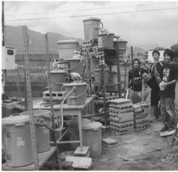
図 109. 千曲川からの灌漑用水路に汚泥ポンプを設置し、粗ろ過の仕組みをいろいろ工夫して実験をしている。日本の山間での小規模浄水施設を考えると、ポンプで水を汲み上げ、水圧調整をし、流速を安定化する。その後、粗ろ過装置を何回か通してから緩速ろ過槽に水を導入するようしている。
