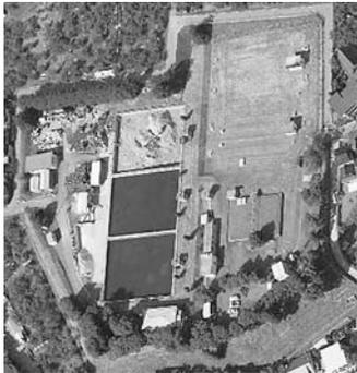
図 98. 貯水池で硫酸銅を散布した水を原水とする浄水場。ろ過閉塞が著しい時は 10 日間で削らないといけない。水源で植物プランクトンが繁殖しないときは、ろ過継続は長い。
