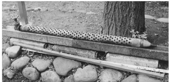
図 107. 砧浄水場の原水は、河川敷に埋設した集水管で伏流水である。欧米などで見直されてきた堤防ろ過方式である。濁りが無い水なら、緩速ろ過処理では、一切、目詰まりしない。ろ過速度も早くても良い。しかし、この浄水場は、維持管理が楽な様にと膜処理施設を導入した。莫大は電気エネルギーを使う施設で、省エネでない。
