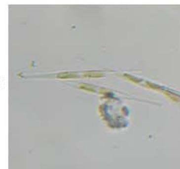
往生地浄水場では、戸隠貯水池で繁殖した藻類が流入している。細胞質が入っていない藻がある。
