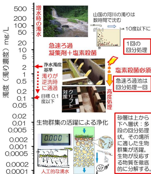
図33 浄化法と濁度
