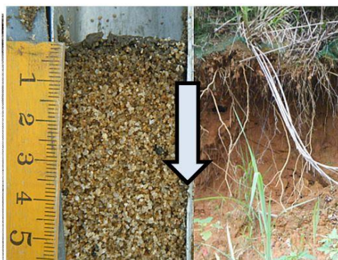
図34 緩速ろ過の砂層は土壌断面と似ている
