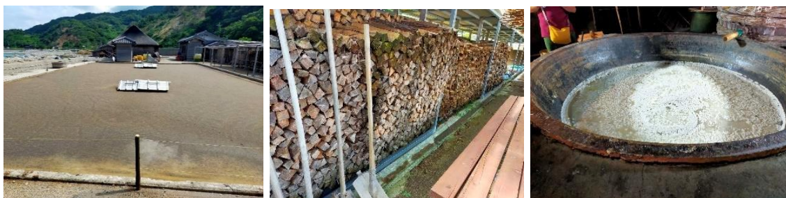
伝統的な揚げ浜式製塩を行う塩田（上左）、近くの山林の薪（上中）を燃料に釜で煮詰める（上右）。
