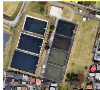
高崎市の剣崎浄水場 (明治 43 年) は河川表流水を取水し、沈殿池とろ過池、配水池だけ
