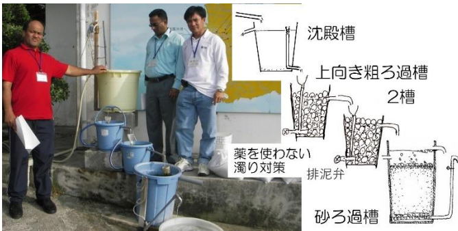
図 12. バケツを使い上向き粗ろ過を説明
