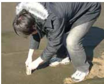
*Fig. 59.2-Uma amostra da camada superior de areia é coletada no momento da remoção de uma camada de areia.*
