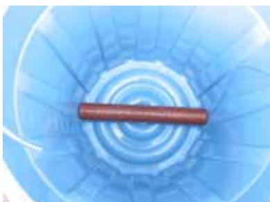
*Fig. 90.4-No fundo do tambor foi instalado um tubo com fendas como coletor de água, sobre o qual se depositam cascalhos e areia. O tubo coletor foi envolvido com um pano para impedir que a areia entre.*
