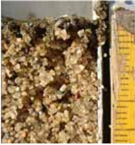
*Fig. 59.3-Condição da parte superior da camada de areia. O lodo (algas e barro) se deposita na superfície, porém, no interior, não há lodo (aspecto da parte superior da camada de areia da Estação de Tratamento de Takazaki, onde o Sistema de Filtração Lenta foi adotado).*
