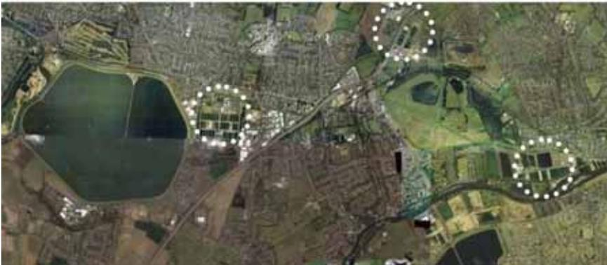
Fig. 49.1-Em Londres, Inglaterra, o tratamento da água é feito 100% por Sistema de Filtração Lenta em Areia. A água rica em nutrientes do rio Tâmis é recolhida e tratada. Nas áreas circundadas com pontos brancos encontram-se as Estações de Tratamento (fonte: mapa extraído do Google-Internet)
