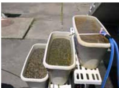
*Fig. 90.3-No primeiro tambor, apareceram colônias de ferro-bactérias e manganês-bactérias, pelo fato da água bruta conter esses elementos dissolvidos. Nesse tambor, um ambiente aquático rico em oxigênio facilita a proliferação de bactérias. A partir do 2º tambor, por não haver mais bactérias, diminui a resistência à filtração.*
