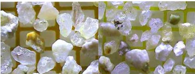
*Fig. 26.1-A foto à esquerda mostra areias usadas no Sistema de Filtração Lenta (Tratamento Ecológico) e, à direita, areias usadas no Sistema de Filtração Rápida. A granulação das areias do primeiro Sistema é menor que a do segundo; ambos são cristais duros. Embora as bactérias tenham um tamanho de 0,001mm, a Filtração Lenta*
