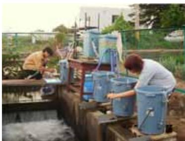
*Fig. 89.1-A água é bombeada e, controlando-se a pressão na caixa, é despejada no tanque de filtração lenta.*
