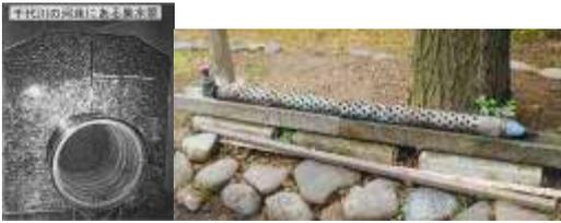
*Fig. 78.1-Um modelo de tubo usado para captação de água bruta. À direita, o modelo utilizado na Estação de Kinuta, em Tóquio.*
