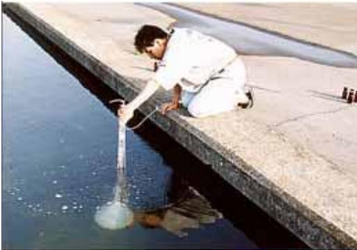
*Fig. 33.1-Mediu-se a concentração de oxigênio dentro da bolha num dispositivo improvisado de coletor de bolhas e constatou-se a alta concentração desse gás. Quando a bolha estava em equilíbrio com o ar, a concentração de oxigênio encontrado foi cerca de 20%. Porém, durante o dia de maior incidência solar, chegou a atingir 40% e, após anoitecer, chegou-se aos 20% pela manhã. Conclui-se por este fato que parte do oxigênio da bolha estava sendo transferida à água.*
