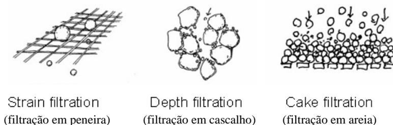
*Fig. 3-Em geral, o processo de filtração pode se dividir em três tipos: 1-filtração por peneira, a mais simples, e de malhas grandes; 2-filtração em camada de cascalho, e 3-filtração em camada de areia fina.*
