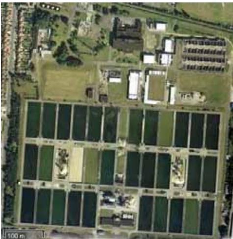
Fig. 49.2-Estação de Tratamento do Ashford Common, a maior do rio Tamisa. Existem nela 32 tanques de filtração com 3,0m de largura e 100m de comprimento. (fonte: Google Mapa)
