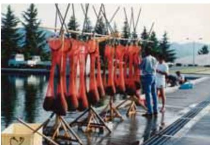
*Fig. 84.1-Volume de algas recolhidas em um tanque de Filtração Lenta de 780m<sup>2</sup>, em apenas um dia. É um desperdício não aproveitá-las.*
