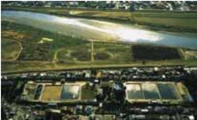
*Fig. 77.2-A Estação de Tratamento de Kinuta-Shimo capta água da nascente do rio, vinda das profundezas, razão pela qual não há matérias em suspensão. A velocidade de filtração é de  $9,5 \text{ m}^3/\text{m}^2/\text{dia}$  e tem capacidade de fornecer  $88.000 \text{ m}^3$  de água potável, atendendo cerca de 300.000 pessoas, por dia.*
