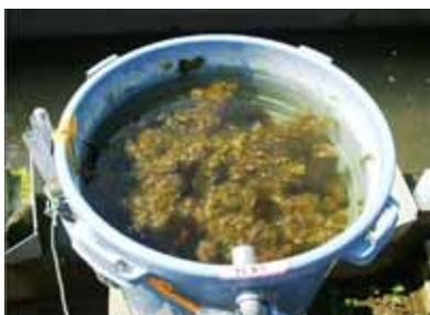
*Fig. 89.2-Dentro do balde do filtro de areia, crescem algas filamentosas. Essas algas viram alimentos para animais e promovem a atividade de microorganismos no interior da camada de areia, produzindo água segura e de boa qualidade.*
