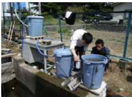
Fig. 40.5-Construíram-se modelos usando tambores, nos quais foi colocada água através de bomba da água. Um dos tambores foi exposto ao sol e o outro não recebeu a incidência de raios solares, para verificar se há diferença na resistência à filtração (perda de carga nominal).
