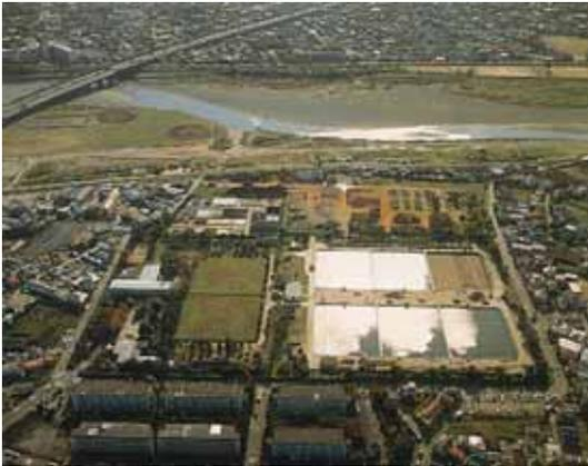
*Fig. 78.2-Estação de Tratamento de Água da Kinuta de Tóquio. A água bruta é captada da nascente do Rio Tama, isenta de materiais em suspensão.*
