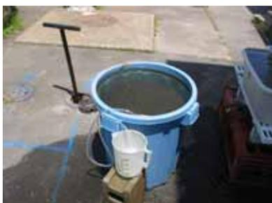
*Fig. 90.5-Para completar a filtração usou-se uma balde de plástico. Na água filtrada não se constatou a presença de coliformes fecais. É uma água segura, sob o ponto de vista bacteriológico. Na foto, embora a água não esteja ainda transbordando, as algas mortas são descartadas, automaticamente, com o excesso de água.*
