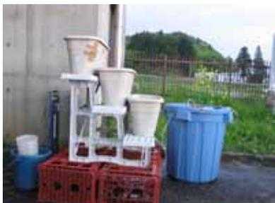
*Fig. 90.2-Um sistema de purificação de água que é possível construir, até num fim-de-semana. Cascalhos e areias podem ser coletados do leito de rios e lavados. O tempo necessário para montagem é pouco mais de meia hora. O sistema é útil nos períodos de estiagem.*
