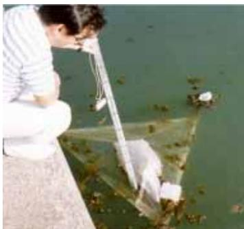
Fig. 45.1-Coletaram-se bolhas utilizando um saco plástico e mediu-se a porcentagem de gás oxigênio.
