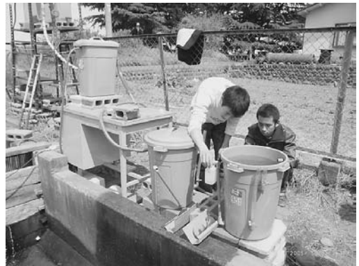
図 46. 河川表流水から大きな濁りを除いたバケツモデルを作って、藻が繁殖する場合と、日が当たらず藻が繁殖できない場合での生物浄化の仕組みを研究した。
