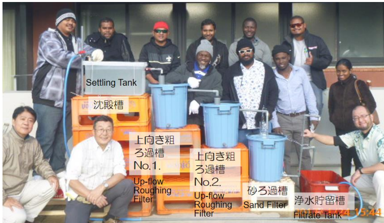
図 O-1 JICA 研修で薬を使わない浄化モデルをつくった JICA trainees made a model of Ecological Purification System.
