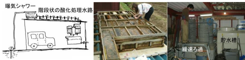
図 33-2 渋い井戸水を曝気して鉍物分を沈殿除去して砂ろ過 Aeration system for astringent underground water.
