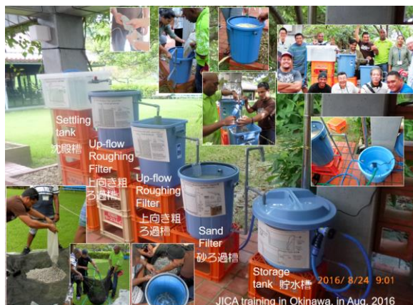
図 O-4 皆で浄化モデルをつくり仕組みを理解してもらう When we made a model, we could understand the system.
